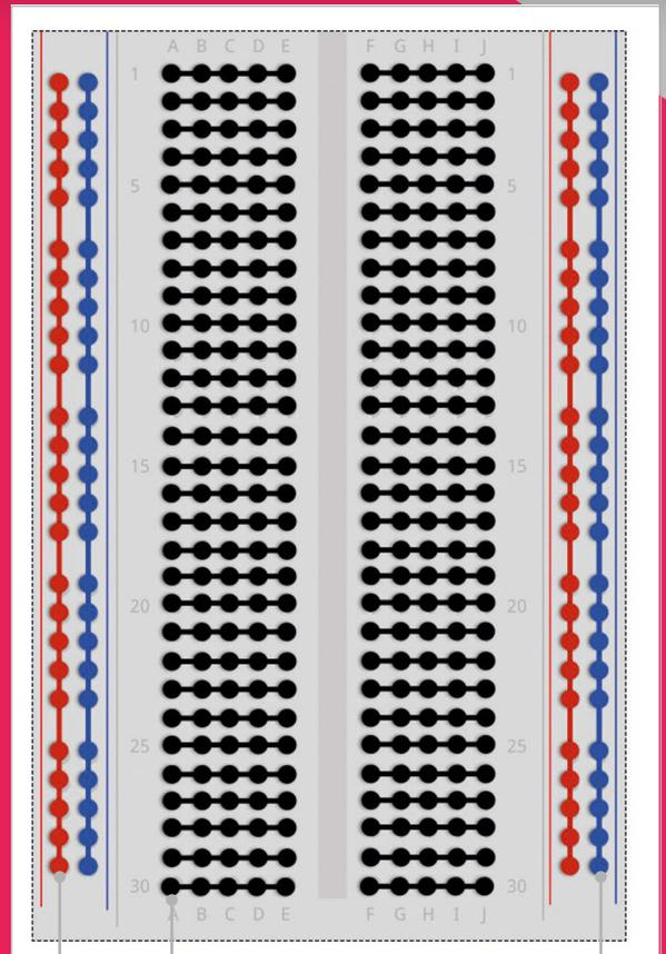
Un trou dans le rail bleu (parfois noir) est connecté à une broche de masse. Cela devient alors le rail de masse.
